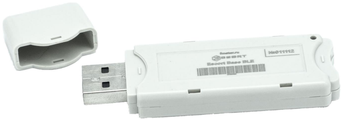
Рис.3.3. Конструкция конфигурационной базы беспроводного датчика угла с автономным питанием «BLE-BASE-USB»
