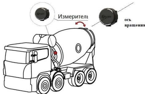
Рисунок 8.1 Размещение DU-BLE на бетоносмесителе в режиме вертикального вращения.
